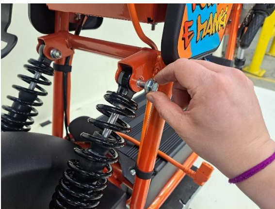
Kiinnitä takajousten yläpäätkä kiinnityspulteilla (kiintoavain 14mm).
