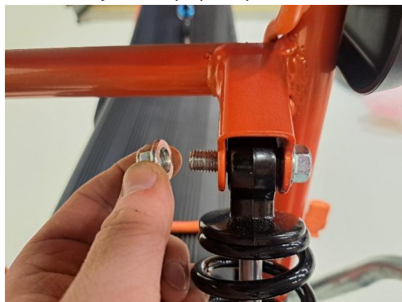
Kiinnitä takajousten kiinnitysmutteri (kiintoavain 14mm)
